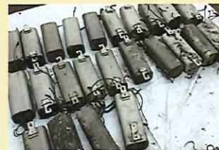
■ 安定器(水銀灯・蛍光灯)
