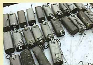
■ 安定器(水銀灯・蛍光灯)
